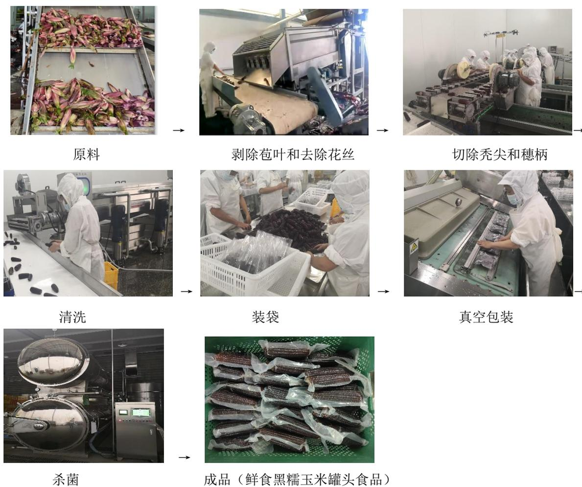
图A.1 工艺流程图
